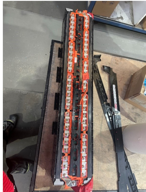
Un des modules 9S du pack d'origine Lexus UX300e (à droite, sans les capots en plastique). Les modules n'ont pas de BMS intégré.
