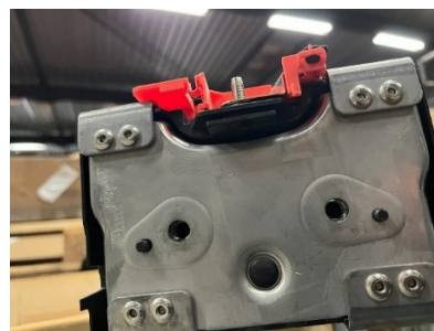
Un des modules 9S du pack d'origine Lexus UX300e (à droite, sans les capots en plastique). Les modules n'ont pas de BMS intégré.
