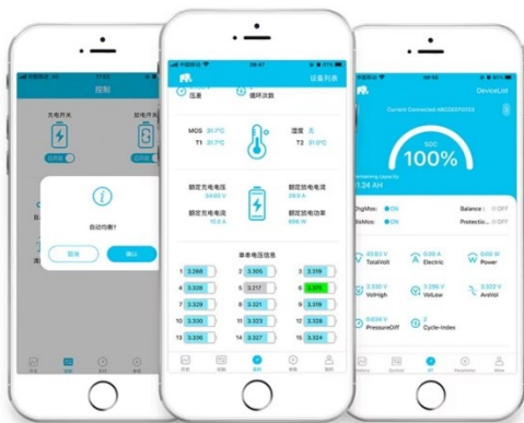
Application de contrôle BMS Jikong et exemple de de câblage
