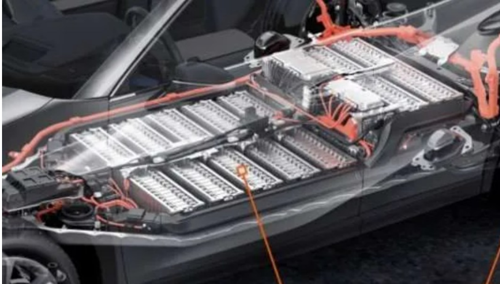
Photos de la batterie dans le véhicule
