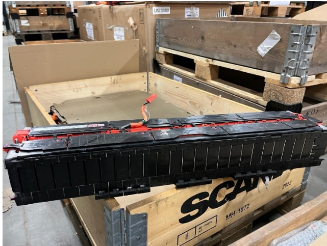
Un des modules 9S du pack d'origine Lexus UX300e (à droite, sans les capots en plastique). Les modules n'ont pas de BMS intégré.
