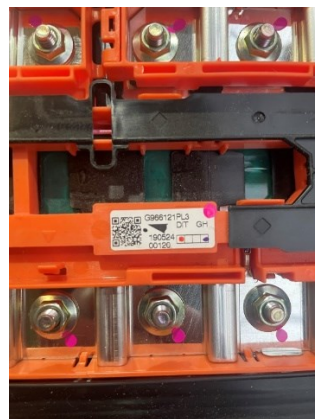
Les cellules sont boulonnées sur des vis M5 soudées aux cellules. Couple de serrage à ne pas dépasser : 3 N.M. (0,3 kgm)
