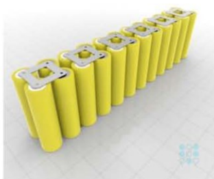
12S2P (cellules 4V type 18650) 48 Volts
