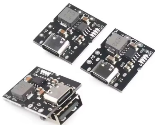
Convertisseur 12V avec protection entrée USB-C + USB-A en option
