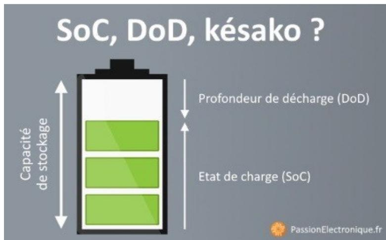
**Le pourcentage de charge :** Le pourcentage de charge n'évolue pas linéairement avec la tension de la batterie. A 3,6 volts par cellule, la batterie est à 50%, mais en-dessous de 3,3 volts, il n'y a déjà presque plus de charge.
