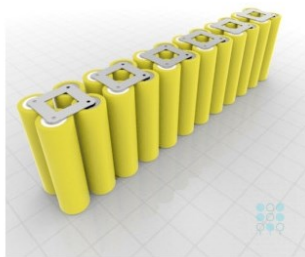
12S2P (cellules 4V type 18650) 48 Volts
